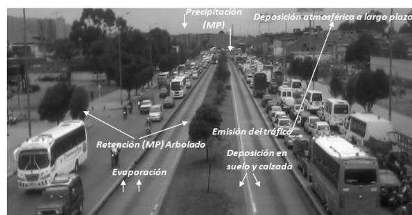
Figura 2. Comportamiento de las emisiones por fuentes móviles en vías urbanas. Adaptada de (Torres & Rodríguez, 2012). Fotografía tomada en mayo 31/2015 en la Autopista sur entre carreras 61 a y 62 b . Área de muestreo en la localidad de Kennedy.
